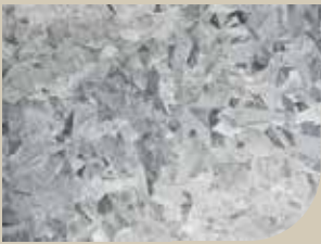
Detalhe do acabamento superficial Chapa Zincada Cristal Normal
